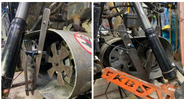
Figura 3 e 4. Captação da Curva Característica da CVT.
